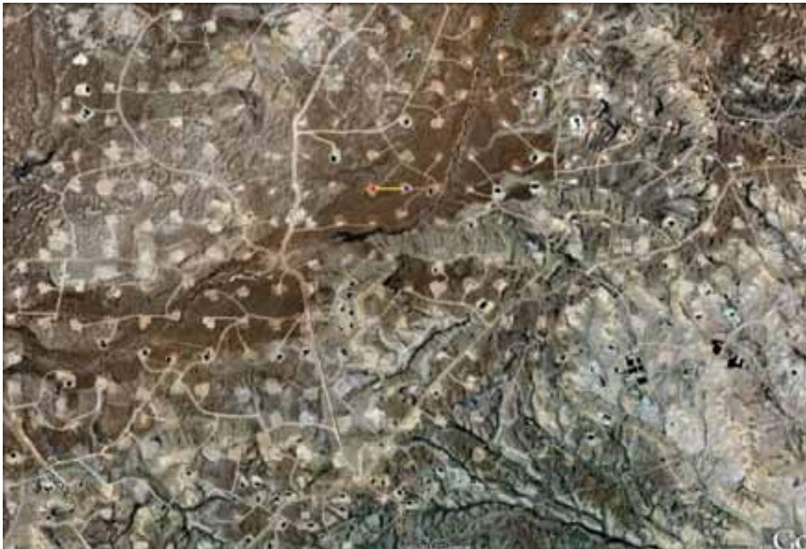
Figure 2 : Image satellite d'une partie du champ Jonah, au Wyoming (extraite de Google Earth le 8 février 2012, image datée du 14 août 2006). Les taches claires sont les plateformes d'exploitation, les rectangles foncés sont les bassins d'eau renfermant soit les fluides de fracturation hydraulique, soit les eaux produites ou de reflux, et les lignes claires sont les réseaux de routes d'accès ou de canalisations. La distance approximative entre les plateformes (ligne jaune) est de 400 mètres, ce qui équivaut à une densité d'une plateforme par 16 hectares (ou une par 40 acres) avant le projet de forage intercalaire. La zone de forage du projet de forage intercalaire dans le champ Jonah s'étend sur environ 30 500 acres (environ 120 km 2 ) au total.
